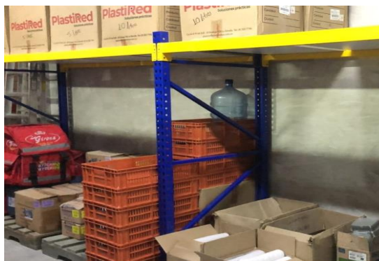
Estanteria metálica semi pesada de ensamble con perforación aguacate, terminada en pintura electrostática. Color a convenir.
